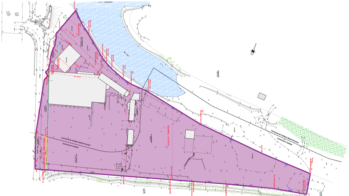
Figure 15 : Zone du site sous les PHEC (24,9 mNGF)
